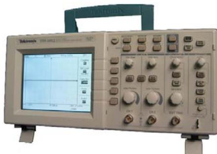
图 1-22 Tektronix 1012 型双通道示波器
